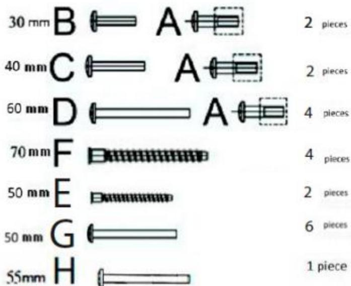
Osa "A" on lukituskiinnike, johon osat "B", "C" ja "D" asetetaan.
